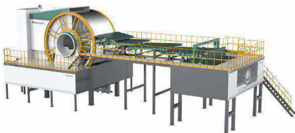
Рисунок 6. Внешний вид машины для сбора ваты, конвейера для сбора нитей и маятника
