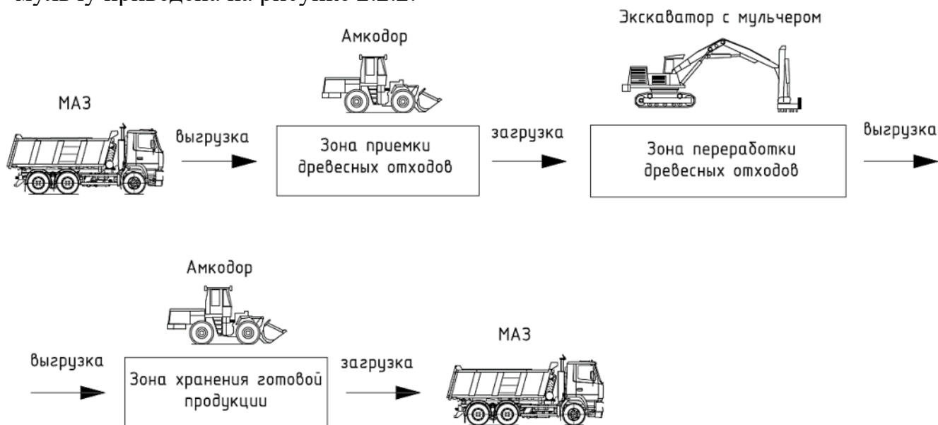
Рисунок 2.2.2 – Схема технологического процесса по переработке древесных отходов в мульчу
